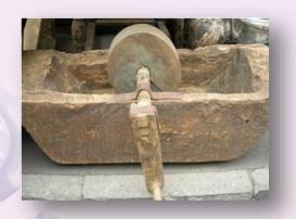
XIX веке. В то время данные станки работали с применением абразивных кругов природного происхождения, которые изготавливали из целостных кусков абразива. Чуть позже был изобретен так называемый карборунд — очень прочный круг искусственного происхождения. Благодаря этому использование шлифовальных станков стало более активным и повсеместным.
